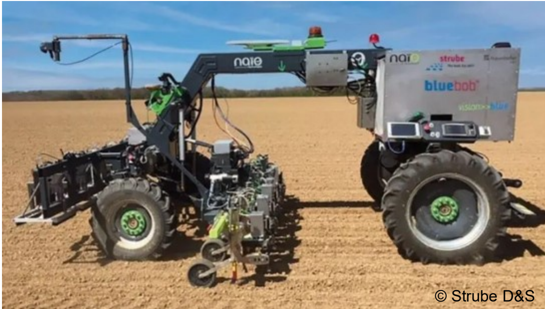
Sechsstreihiges Unkrauthacken mit autonom navigierendem Feldroboter BlueBob
