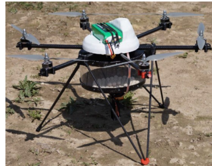
Multikopter zur Ausbringung von Trichogramma-Kapseln in Mais (Foto: Jörg Jenrich, LTZ)
