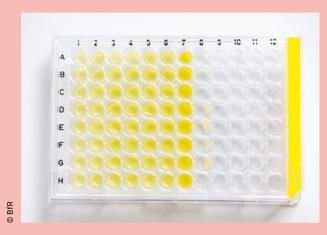
**Doppelte Dosis: Mit Mikrotiterplatten lassen** sich Chemikalien in verschiedenen Konzentrationen parallel testen.
