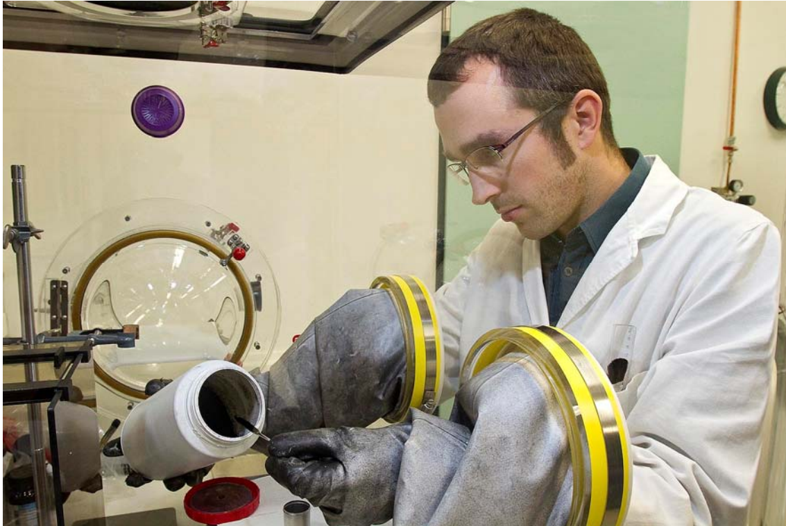
Abbildung 4: Handhabung von Nanomaterialien in einer Glovebox als Beispiel für ein geschlossenes System am Arbeitsplatz (Bildquelle: BAuA/Völkner)
